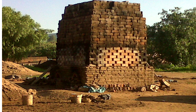
Horno rectangular o campaña, de tiro ascendente. En una ladrillera cercana a la ciudad de León.
