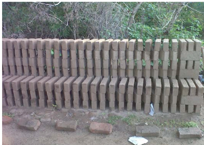
Ladrillos crudos, estibados para su secado. En una ladrillera cercana a la ciudad de León.
