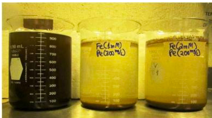
Fig. 3. Tratamiento Fenton: efluente original (izquierda); al centro (efluente tratado con [\text{Fe}^{2+}]_o = 1 \text{ mM} y (\text{H}_2\text{O}_2)_o = 300 \text{ mg/L} ) y a la derecha (efluente tratado con [\text{Fe}^{2+}]_o = 2 \text{ mM} y (\text{H}_2\text{O}_2)_o = 200 \text{ mg/L} ).
