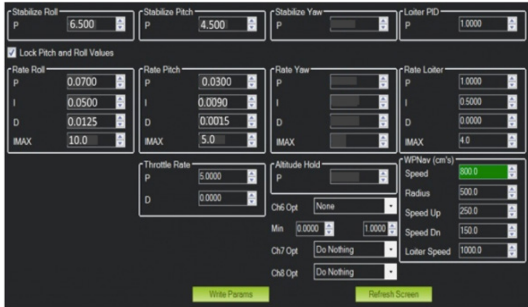
Fig. 7. Parámetros en interface Mission Planner. Fuente: Interface Mission Planner configuración de dron.
