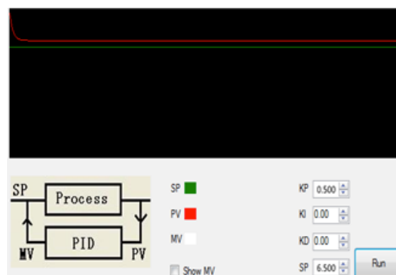
Fig. 4. Simulación de P con un valor estable de 6.500. Fuente: Elaboración propia Interface creada en C# para simulación de PID.
