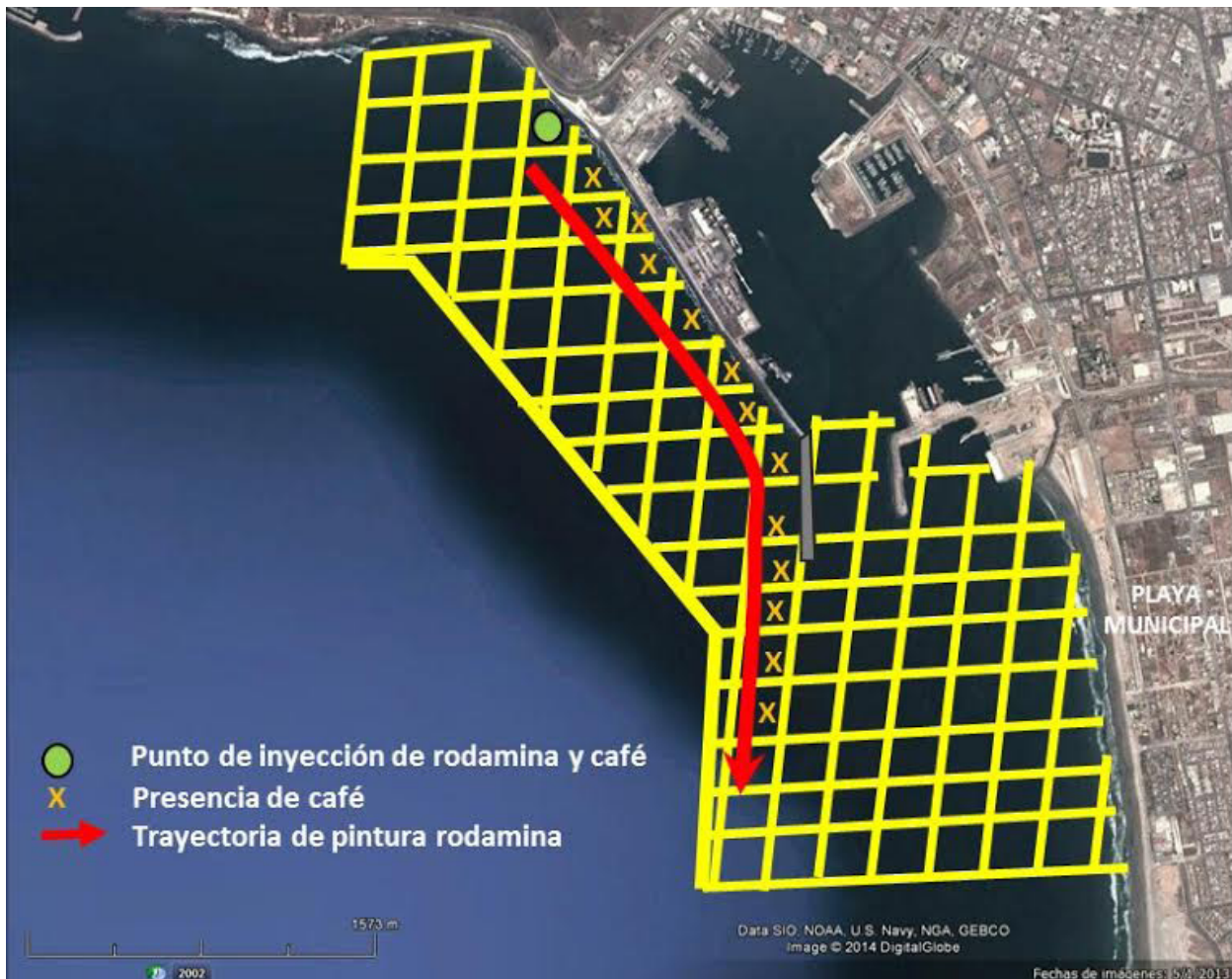
Figura 7. Patrón de corrientes y transporte litoral en condiciones de oleaje de verano con la modificación al rompeolas.
