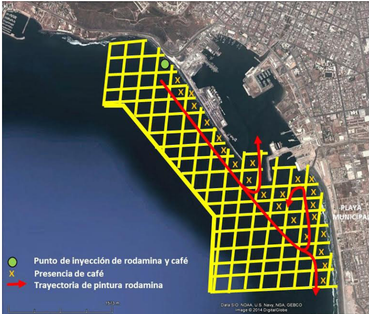
Figura 6. Patrón de corrientes y transporte litoral reproduciendo las condiciones de oleaje de verano y el estado actual del rompeolas.
