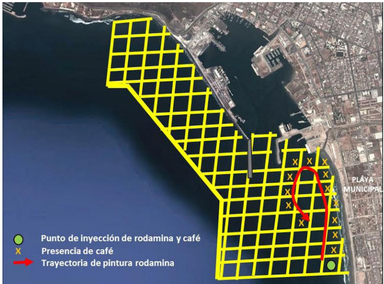
Figura 8. Patrón de corrientes y transporte litoral para dirección de arribo representativo para condiciones de invierno en condiciones actuales.
