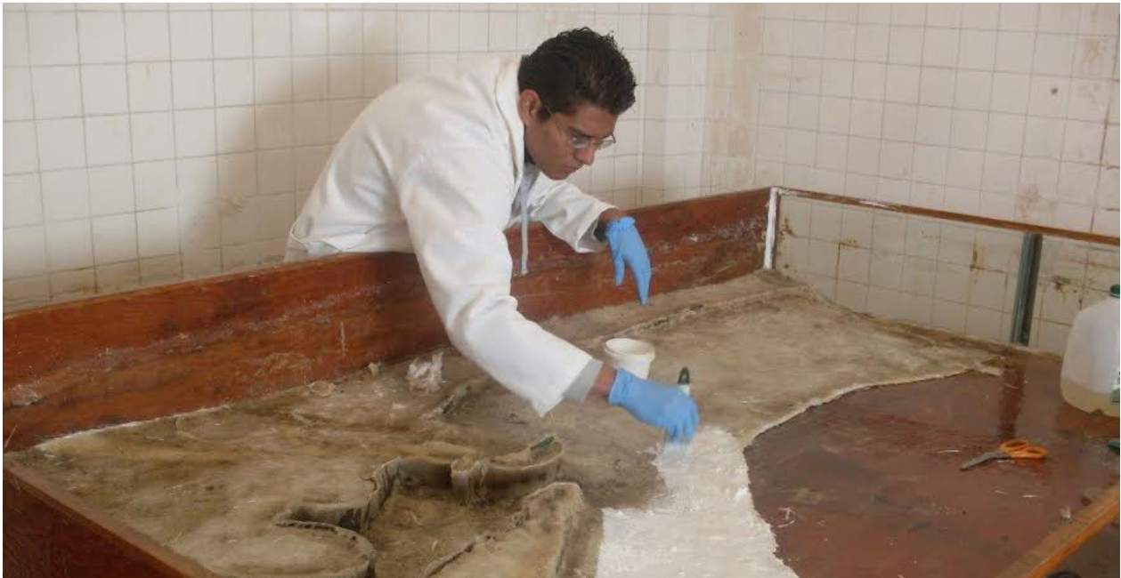
Figura 2. Construcción del modelo a escala del puerto de Ensenada y zonas aledañas.
