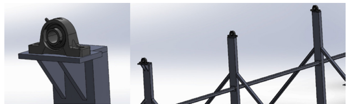
Figura 5. Base con nervios para el soporte de las chumaceras. Fuente: elaboración propia
