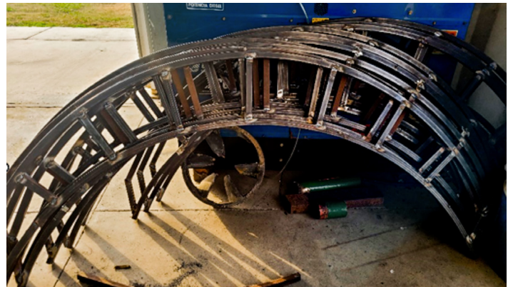
Figura 14. Bases de forma de parábola hechas con PTR de 2.5 cm C18. Fuente: elaboración propia
