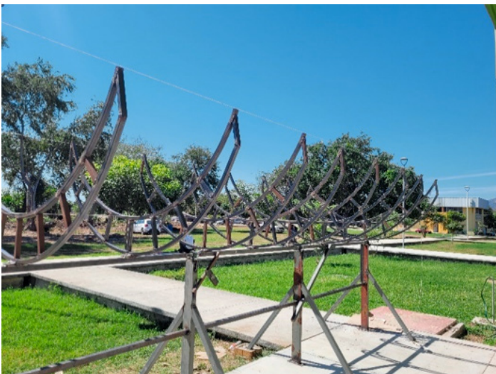
Figura 17. Estructura de la parábola, acoplada al eje de torsión. Fuente: elaboración propia
