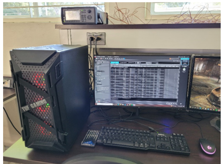
Figura 11. Adquisidor de datos DAQ970A y PC para captura de datos. Fuente: elaboración propia
