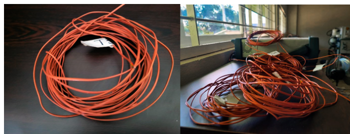
Figura 12 Cable termopar tipo K AWG 24. Fuente: elaboración propia
