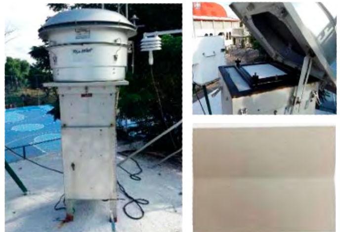
Figura 3. Equipo manual Tisch Environmental Hi Vol. En la parte superior derecha se muestra la instalación del filtro y en la parte inferior derecha el filtro impactado.
