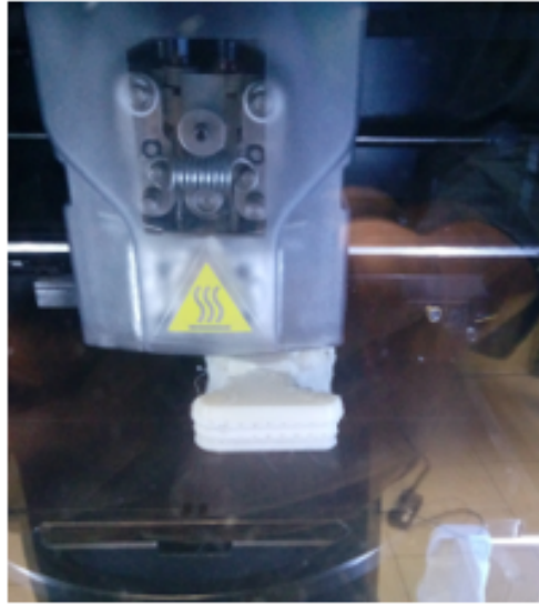
Figura 3. Proceso de prototipado con defecto. Fuente: elaboración propia.
