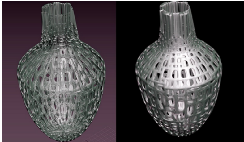
Figura 13. Deformación topológica diagramas de Voronoi. Se empleó software 3D Max Studio 2018 de Autodesk. Fuente: elaboración propia.
