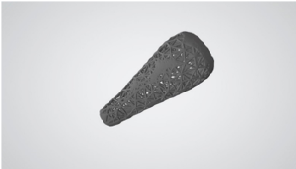
Figura 10. Deformación topológica estructura por trabécula. Se empleó software 3D Max Studio 2018 de Autodesk. Fuente: elaboración propia.
